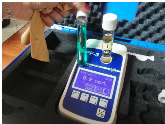
Slika 2: Analiziranje vzorcev prsti s fotometrom Vir: Povalej, 2019
