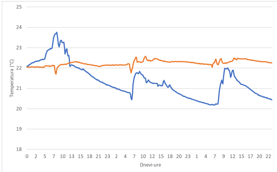
Slika 7: Gibanje temperature v prostoru glede na delovanje in upravljanje termostatskih ventilov
